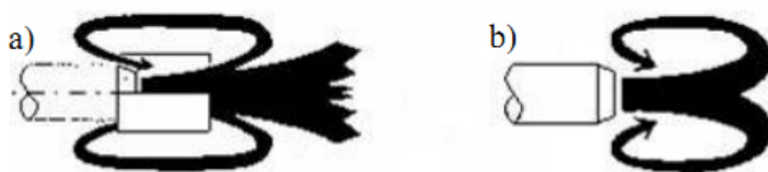
图4-4 烟气内循环:a)再循环罩, b)射流卷吸
